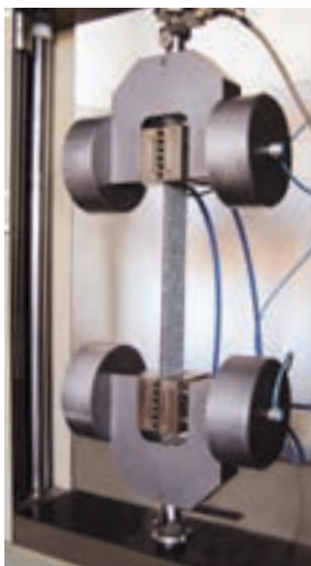
Bestimmung des Zug-Dehnungsverhaltens nach EN 12311-1.
