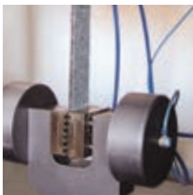
Bestimmung des Zug-Dehnungsverhaltens nach DIN EN 12311-1.
