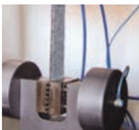
Bestimmung des Zug-Dehnungsverhaltens nach EN 12311-1.
