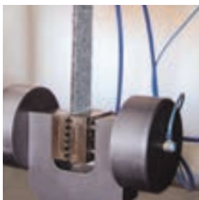
Bestimmung des Zug-Dehnungsverhaltens nach EN 12311-1.
