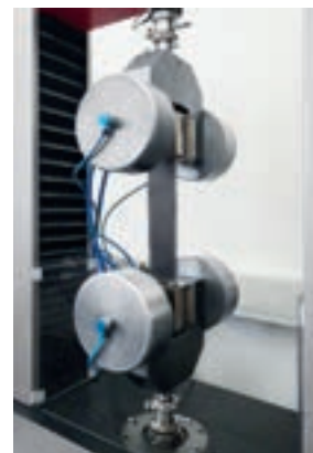
Bestimmung des Zug-Dehnungsverhaltens nach DIN EN 12311-1.
