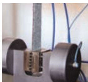
Bestimmung des Zug-Dehnungsverhaltens nach EN 12311-1.
