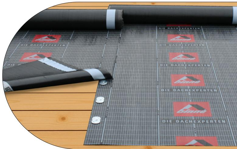
Die POLY ULB-NAGELRAND 35 mit werkseitig integrierter Sicherheits-Schweißnaht ist die ideale Wahl für den Einsatz als untere Lage (DU) in einem mehrlagigen Abdichtungsaufbau. POLY ULB-NAGELRAND 35 ist für eine mechanische Befestigung geeignet und zugelassen. Sie eignet sich für die lose Verlegung mit mechanischer Befestigung auf Holz- und Holzwerkstoffen, sowohl bei Neubauten als auch bei der Sanierung von Dachflächen nach DIN 18531 sowie den weiteren anerkannten Regeln der Technik. Mit einem
